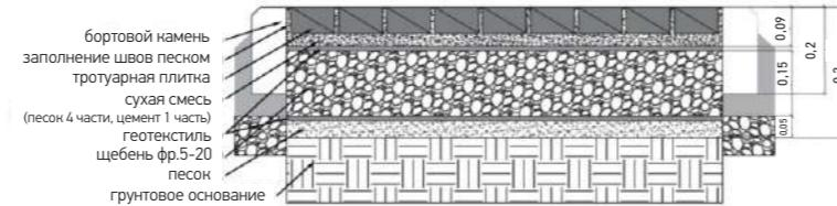
Конструкция устройства основания под автомобильные нагрузки (автомобиль до 5 тонн)\* на щебневом основании
