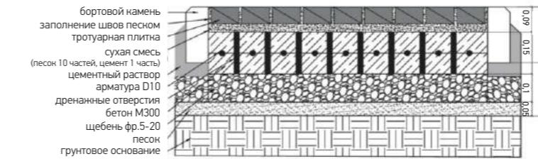
Конструкция устройства основания под пешеходные нагрузки
